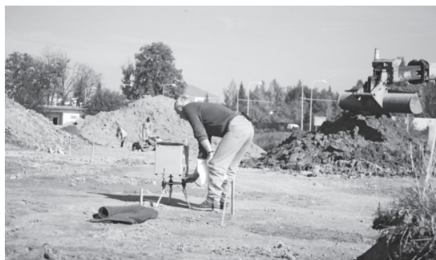
Obr. 24. Jihlava – Staré Hory I, archeologický výzkum silničního obchvatu I/38 v roce 2002. Geofyzikální měření povrchu zasutých středověkých těžních jam na výzkumné ploše po skrývce (geologický radar a mikrogravimetrie, G-IMPULS Praha). Foto archiv ARCHAIA Brno.
