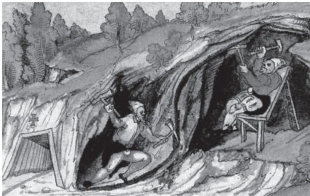
Obr. 13. Ražba štol a těžba rudy pomocí mlátku a želízka. Das Schwazer Bergbuch, Ludwig Läßl (texty) a Jörg Kolber (iluminace), polovina 16. století.
