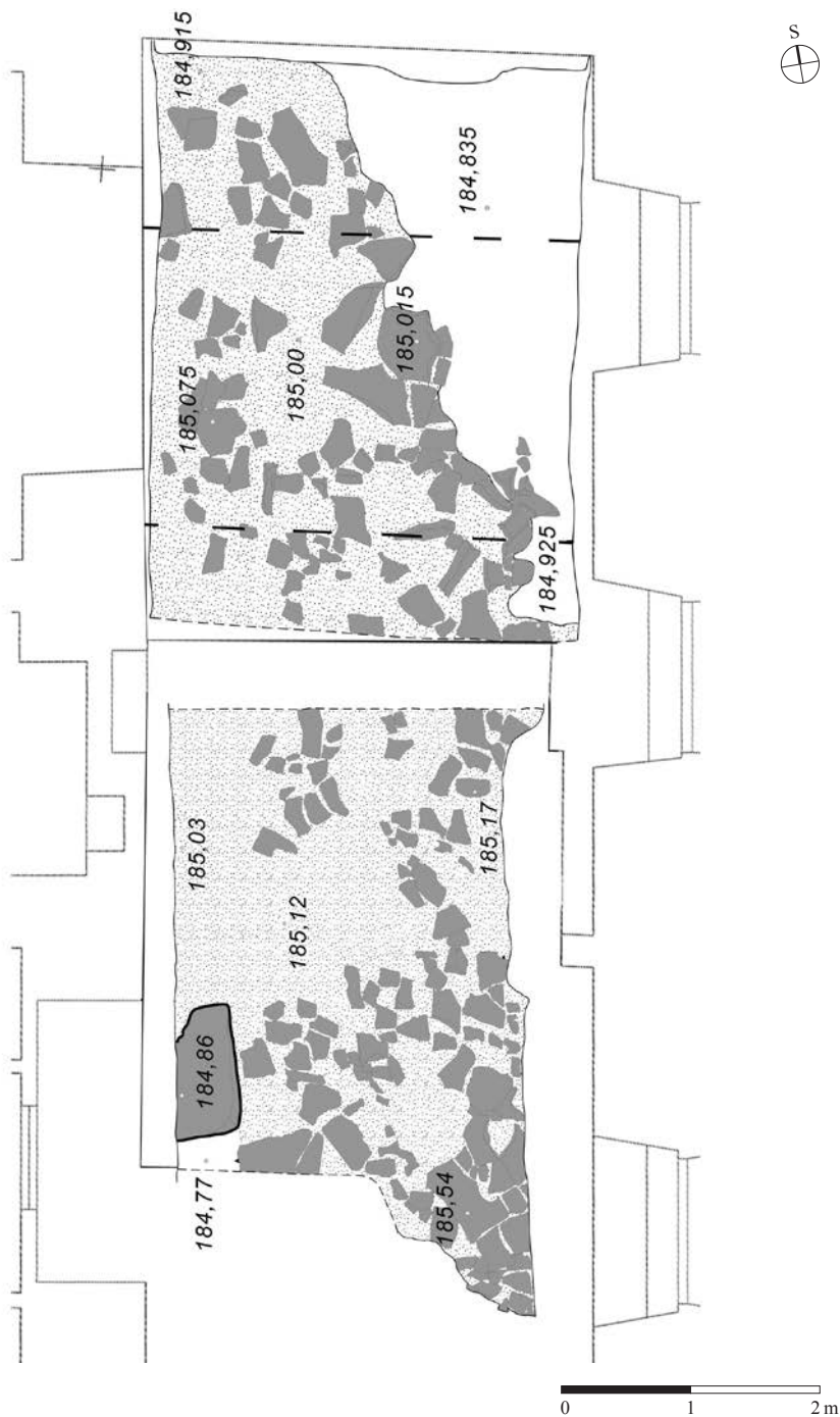
Obr. 13. Praha – Kampa. Pilíř Juditina mostu v místnosti 7 a sondě S 29; kameny jádra šedě; zesílený obrys – potenciální kámen pláště; bílá plocha – zdivo zalité spodní vodou; čárkovaně – poloha profilů. Kresba J. Kopřivová.
