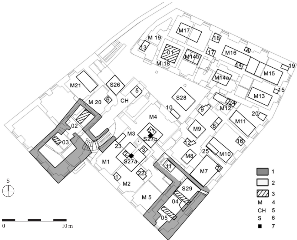
Obr. 6. Praha – Kampa. Rozložení sond v objektu. 1 – sklepy; 2 – statické sondy 1–25 dokumentované ARÚ AV ČR, Praha, v. v. i., v roce 2014; 3 – výzkum NPÚ 2013, sondy 01–05; 4 – číslování místností; 5 – chodba; 6 – sondy S 26–29 z roku 2015; 7 – kamenné pilíře klenuté barokní prádělny.
