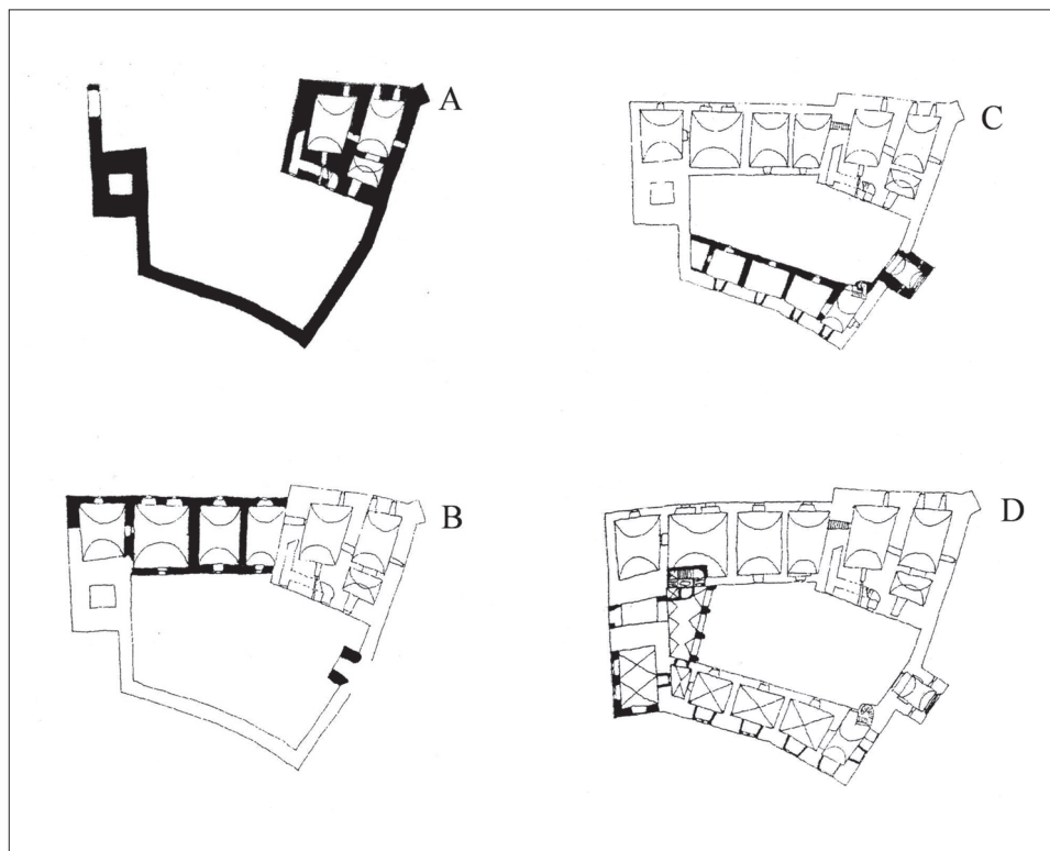
Obr. 3. Model stavebního vývoje Hrubého Rohozce dle P. Vlčka (1999, 264–265). Půdorys A I. stavební etapa – kolem roku 1300 až druhá polovina 15. století. Půdorys B a C II. stavební etapa o dvou fázích – kolem roku 1500 až dvacátá léta 16. století. Půdorys D IV. etapa – pozdně renesanční etapa – pro roce 1593 až 1613.
