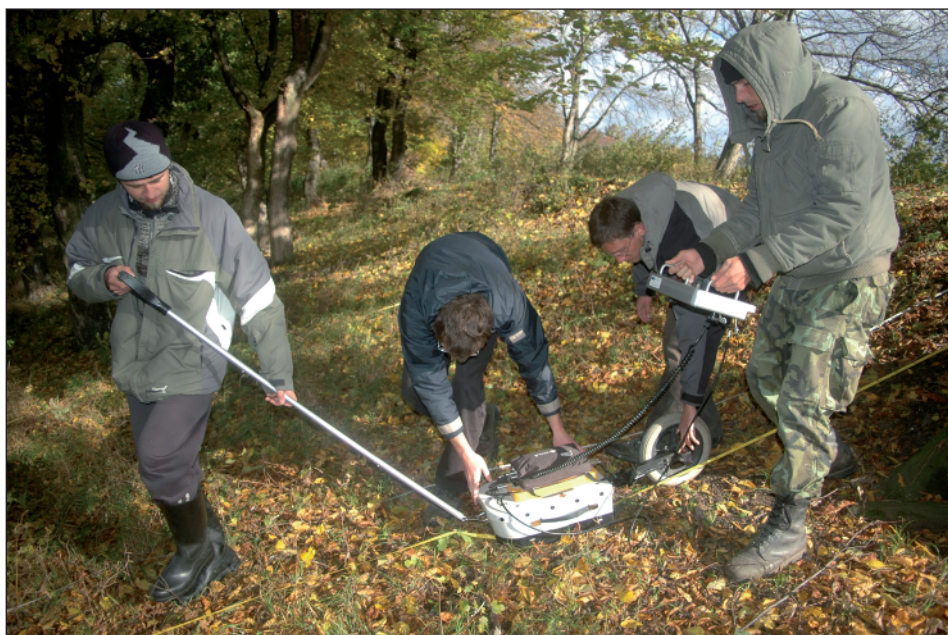
Obr. 2. Práce studentů s georadarem při měření valu na velkomoravském hradišti Břeclav-Pohansko.
