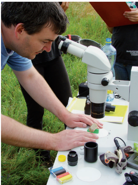
Obr. 146 a 147: Fixace vzorků pro opakované mikrofotografování, vlhčení vzorku před fotografováním. Foto Jan Petřík.
