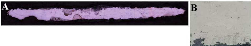
Obr. 5. Lamela 5. A – přehledový snímek příčného řezu lamelou, metallografický výbrus, leptáno Nitalem; B – hrubozrnný ferit. Foto J. Savková.
