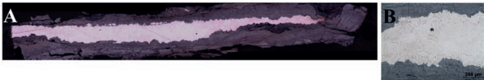
Obr. 2. Lamela 2. A – přehledový snímek příčného řezu lamelou, metalografický výbrus, leptáno Nitalem; B – hrubozrnný ferit. Foto J. Savková.
