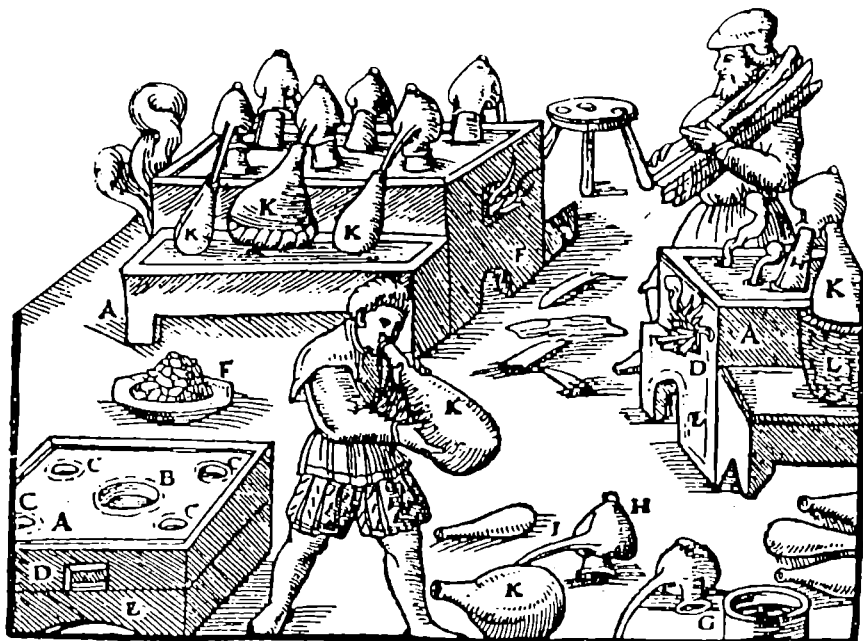
Obr. 9. Vlevo dole a vpravo pece k destilaci, nahoře pec k žihání a destilaci s baňkami v písčné lázni (Agricola 1933, obr. s. 378; „Pec A. Její okrouhlý otvor B. Průduchy C. Ústí peci D. Popelník pod ním E. Pánev F. Baňka G. Poklop H. Jeho nosák I. Jiná baňka K. Košík na uložení baňky, aby se nerozbita L.“).
