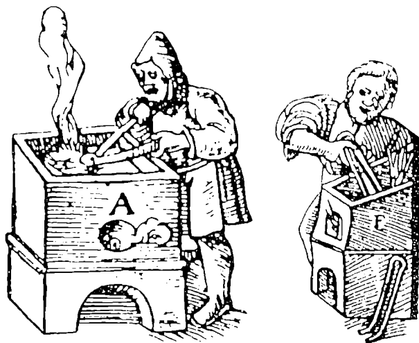
Obr. 12. Pece, jež nasávají vzduch průduchy (Agricola 1533, vlevo obr. s. 386: „Pec, do níž se nasává vzduch otvory A“, vpravo obr. s. 383).
