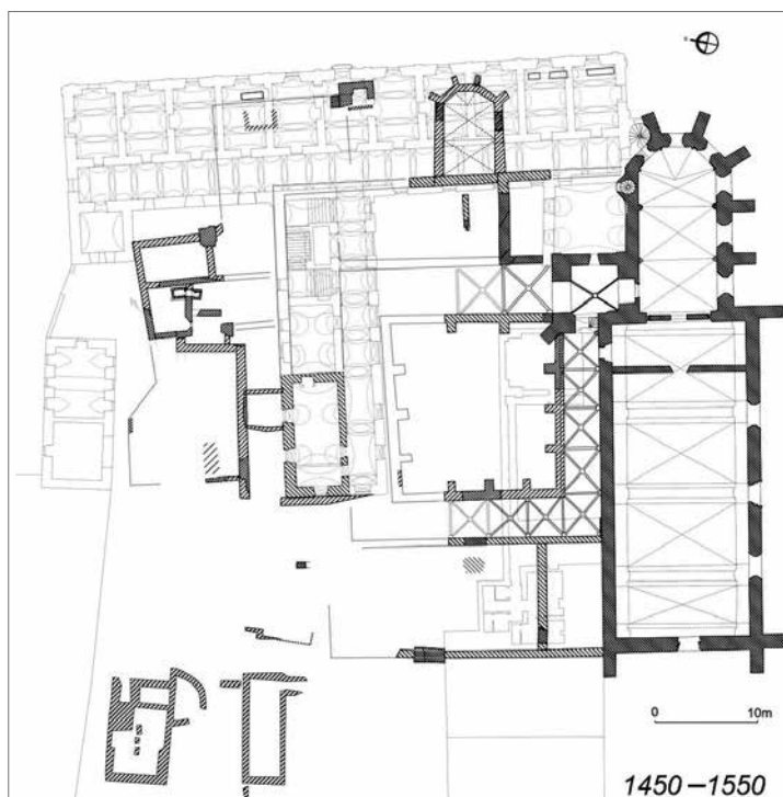
Obr. 10. Náčrt stavebného vývoja v areáli dominikánskeho konventu v troch chronologických rámcoch. Naznačený pôdorys kostola vo fáze 1250–1300 je iba hypotetický. Kresba R. Rusnák.
