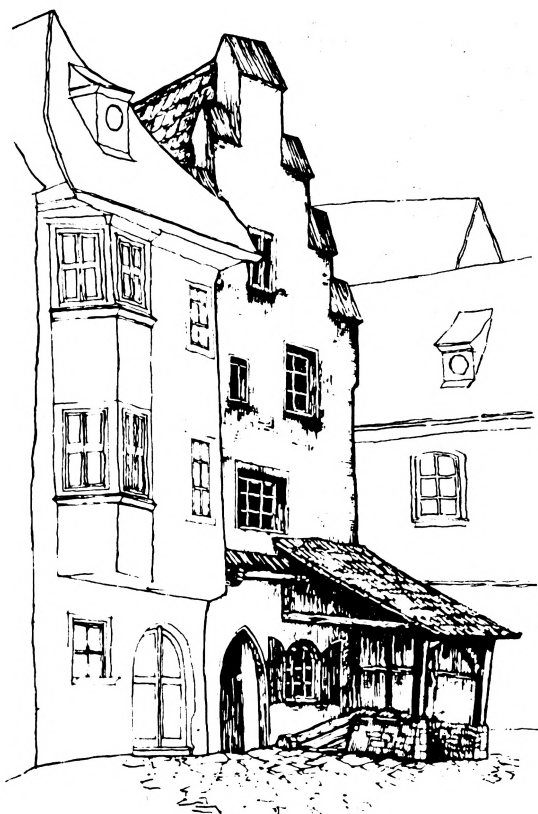
Ob- 8. Egisheim — gotický síňový dům s krytým sestupem do sklepa.
