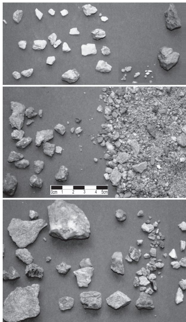
Obr. 244. Ukázky nadrceného či mletého barytu a dalších rudních minerálů obsažených v sedimentech Koželužského potoka, podrobených šlichové prospekci. V těchto materiálech byla místy přimíšena také namletá struska. Foto K. Malý, P. Starústková, úprava P. Hrubý.
