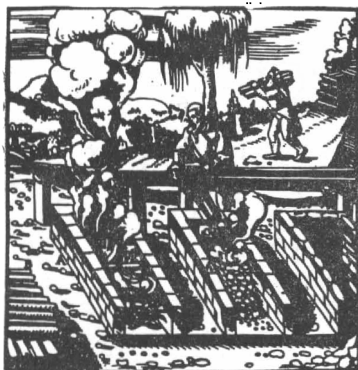
Obr. 9. 1-3 - metalurgická pec (štádlo), 4 - vyobrazenie štábla podľa Agricolu z r. 1556, 5 - zaoblený kus železa, pravdepodobne lopatky (z pece).
