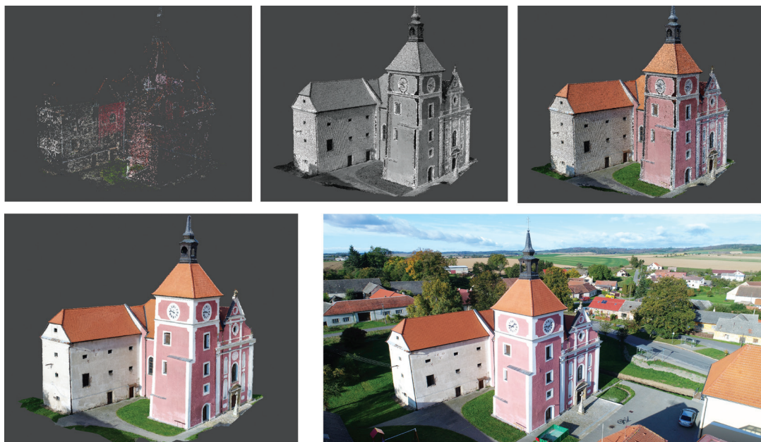
Obr. 1. Kostel Povýšení sv. Kříže v Knínicích, okr. Jihlava (HOP). Tvorba 3D modelu z dat získaných leteckými pracemi v jednotlivých fázích od mračna bodů po finální produkt v porovnání se skutečným stavem. Autor modelu Ing. Ivan Klíma, foto a úprava autor 2019–2020.
