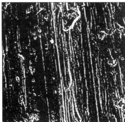
Obr. 4. Snímky z REM dokazujúce technológiu sústruženia: Makropohľad na obrobenú plochu (č. 1). Detail obrobeného povrchu so stopami po nástroji. Viditeľné sú deformácie dráhy nástroja na nečistotách materiálu. Zväčšenie: 300× (č. 2), Detail obrobeného povrchu s prerušením stopy po nástroji pri otvorení stiahnutiny (dutiny), ktorá vznikla pri odlievaní. Zväčšenie: 1200× (č. 3).
