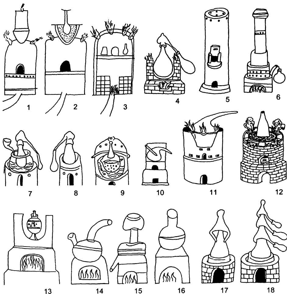
Obr. 17. Různé typy pecí používaných alchymisty a zvaných nejčastěji Athanor ; podle originálních předloh překreslil autor: 1–3 – destilační zařízení a pece (Priesner 1998, 265, obr. 12; De operationibus alchymiae , latinský rukopis, 14./15. stol., Bayerische Staatsbibliothek, Mnichov, Clm 405, fol. 171v); 4 – destilační pec s destilačním zařízením (Priesner 1998, 266, obr. 4; Das Buch der Heiligen Dreifaltigkeit , německý iluminovaný rukopis z r. 1400, Bayerische Staatsbibliothek, Mnichov, Cgm 598, fol. 77r); 5 – destilační či sublimační pec (Priesner 1998, 280, obr. 2; Libri 7 Gebri de summa perfectionis secretorum naturae , latinský rukopis z r. 1531, Bayerische Staatsbibliothek, Mnichov, Clm 2848, fol. 30v); 6, 13–16 – různá destilační a sublimační zařízení a pece s příslušenstvím, 15./16. stol. (Priesner 1998, 284, obr. 10–11; Bayerische Staatsbibliothek, Mnichov, Clm 25110 fol. 10r, 10v, 11r); 7–9 – různé alchymistické pícky používané při separaci a putrfakci (Klossowski de Rola 1991, 124–125; Anonym, 15. stol., british Museum, Londýn, Harley 2407, f 106v–111); 10 – kresba alchymického aparátu ( Opus Magnum , obr. 39; rukopis Strahovského kláštera, sign. DG V. 19); 11 – pícka s destilačním zařízením (Read 1944, 241, obr. C); H. Bruinschwick, Buch zu Destillieren , Strassburg 1519); 12 – alchymistická pec ( Opus Magnum , obr. 42; Geber, De Alchimia , oddíl De Fornacibus construendis , liber I. Norimberk 1541); 17–18 – pícky s destilačními a separačními zařízeními (Klossowski de Rola 1991, obr. 8; Norton's Ordinall, 15. stol., British Museum, Londýn, Add. 10.302, f. 37v.). Překreslil autor.
