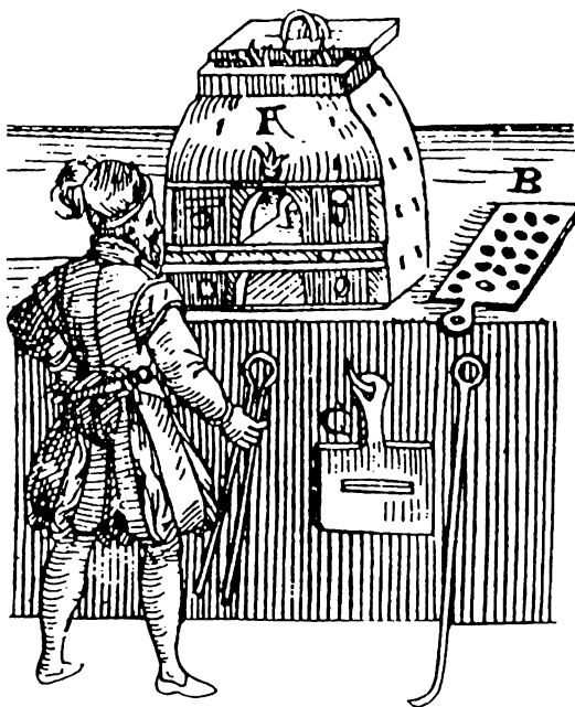
Obr. 6. Prubíř v dílně před prubířskou pískou (Ercker 1974, obr. s. 117, text s. 118: „Prubířská pec, v níž prubíř zkouší A. Železný plech, na nějž se vylévají průby B. Dřevěné zařízení, jehož šterbinou se díváme do pece, aby oheň neškodil zraku C.“).
