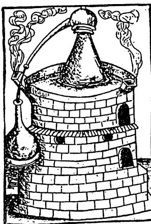
Obr. 15. Vlevo – písmolijec používá pícku k tavení liteřiny (Kneidl 1989, 73; Hans Sachs, Eigentliche Beschreibung aller Stände auf Erden , Frankfurt a. M. 1574, dřevorez Josta Ammana), uprostřed a vpravo pícky s destilačním zařízením při výrobě kořalky (Renfrow 1997, obr. s. 209, 207).
