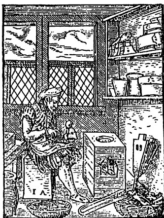
Obr. 15. Vlevo – písmolijec používá pícku k tavení liteřiny (Kneidl 1989, 73; Hans Sachs, Eigentliche Beschreibung aller Stände auf Erden , Frankfurt a. M. 1574, dřevorez Josta Ammana), uprostřed a vpravo pícky s destilačním zařízením při výrobě kořalky (Renfrow 1997, obr. s. 209, 207).
