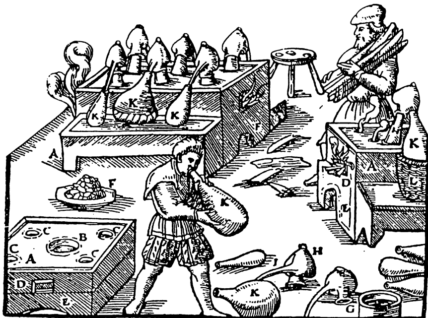
Obr. 9. Vlevo dole a vpravo pece k destilaci, nahoře pec k žhání a destilaci s baňkami v písečné lázni (Agricola 1933, obr. s. 378: „Pec A. Její okrouhlý otvor B. Průduchy C. Ústí peci D. Popelník pod ním E. Pánev F. Baňka G. Poklop H. Jeho nosák I. Jiná baňka K. Košík na uložení baňky, aby se nerozabila L.“).
