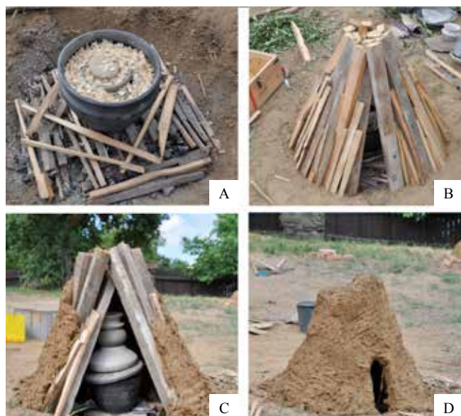
Obr. 3. A – grafitové vzorky v nádobě zasypané pilinami; B – dřevěná konstrukce milíře z trámků; C – průřezový pohled na keramiku uvnitř milíře, dřevěnou konstrukci a nedokončený mazanicevý omaz; D – hotový milíř před výpalem.
