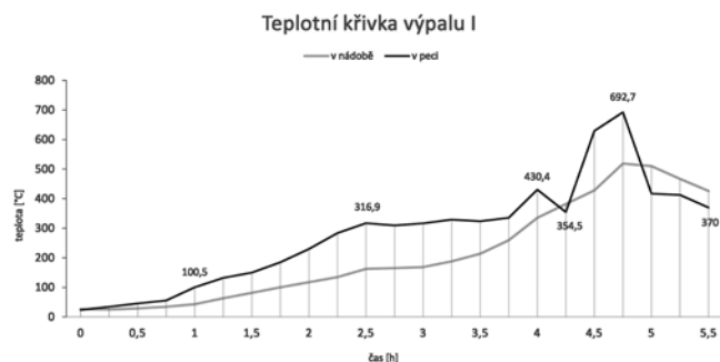
Obr. 5. Teplotní křivka prvního výpalu v milíři.
