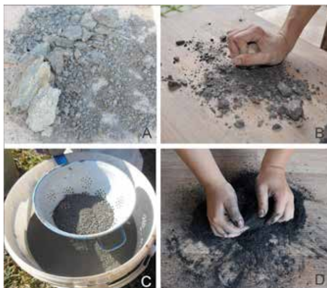
Obr. 1. A – přírodní grafit; B – drcení grafitu; C – přesívání grafitu; D – zapracování grafitu do keramické hmoty.
