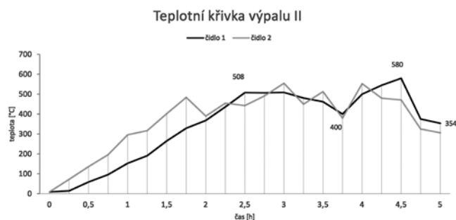
Obr. 6. Teplotní křivka druhého výpalu v milíři.
