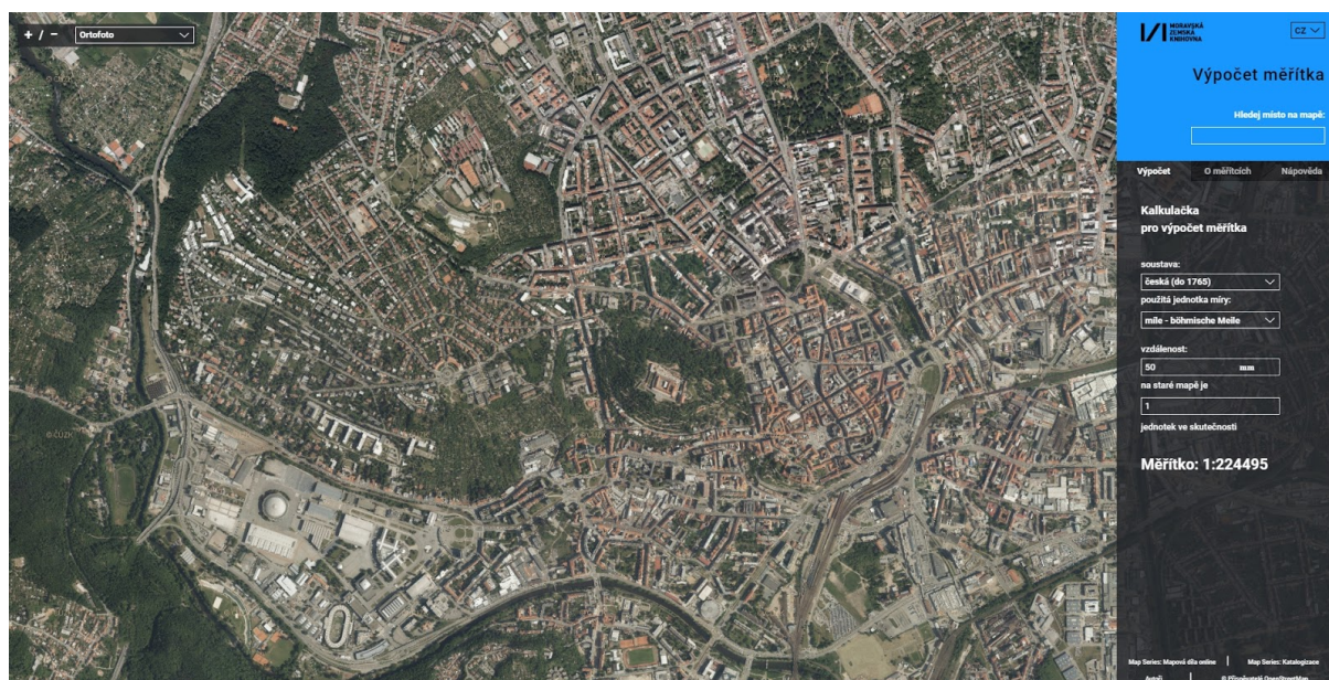
Obr. 5 Výpočet měřítka v případě, kdy je na mapě uvedeno grafické měřítko
