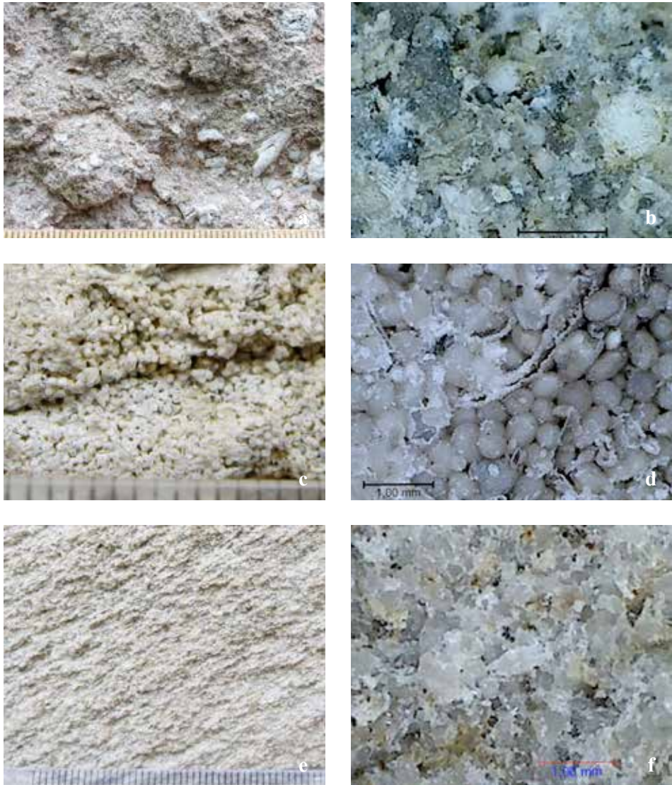
Obr. 8. Makroskopické a mikroskopické snímky kameňov Kostola sv. Mikuláša. a–b – hybridný pieskovec; c–d – oolitický vápenc; e–f – kremenný pieskovec. Foto D. Pivko.
