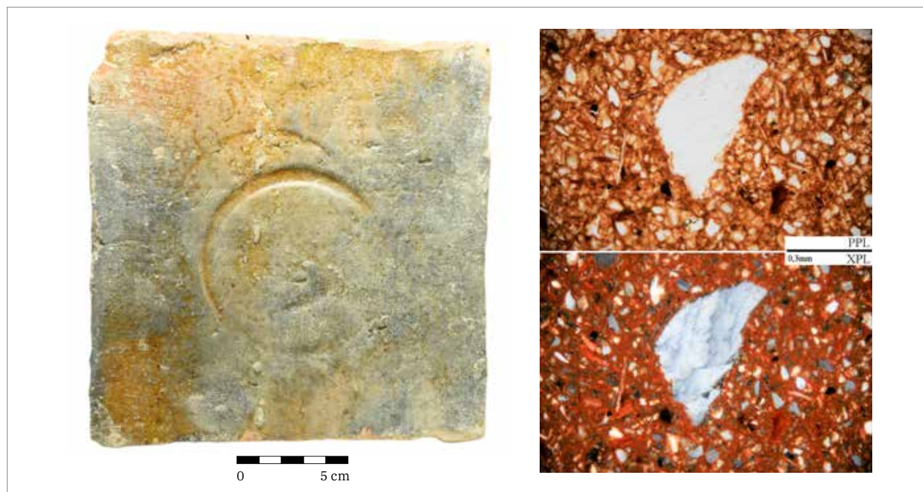
Obr. 21. Brno, Panenská ul. 1 – Centrální motiv kruhu špatně odformován, patrně zmetek; 2 – úlomek křemene v mikrostrukturu keramického střepu, PPL, XPL.
